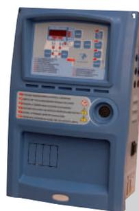
Grâce à ce dispositif, vous pouvez transformer votre groupe électrogène portable en une source d'énergie alternative en cas de rupture de courant. Il s'agit d'une armoire électrique qui fait l'interface entre le secteur et votre groupe électrogène. Lorsque l'alimentation secteur s'arrête, l'armoire électrique met en route votre groupe électrogène. Lorsque le courant revient, l'armoire coupe le groupe. Uniquement pour groupes équipés d'un module DES et/ou prise ILME.
