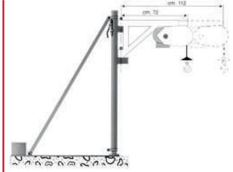
Avec élévateur à potence télescopique
