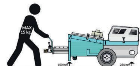
Extrêmement maniable et légère. Facile à déplacer sur les chantiers grâce à une garde au sol élevée. Le poids max. supporté par l'opérateur lorsqu'il déplace la machine sur un chantier est de 15 kg (malaxeur installé).
