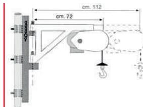
Avec élévateur à potence télescopique
