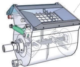
Malaxeur à axe horizontal forgé pour une efficacité maximale
