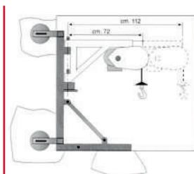
Avec élévateur à potence télescopique
