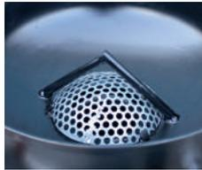
Protection du cône de fermeture.
