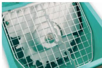
Roue à cellules pour une alimentation optimale de la chambre de malaxage quelque soit le type de matériaux prêt à l'emploi utilisés
