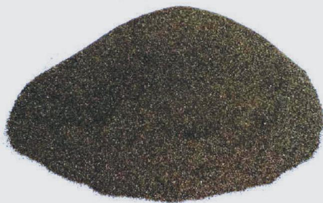
Issu de chambres de fusion, le silicate d'alumine AF 25 est un granulat adapté aux travaux d'aérogommage. Classifié non dangereux selon les ordonnances EC 67/548/EEC et (EC) 1272/2008, l'AF 25 ne contient pas de silice libre, ne présente pas de toxicité aquatique et est non combustible.
