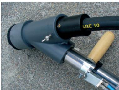
Dans le cas d'utilisation de corindon, il est conseillé d'utiliser une buse en carbure de bore en remplacement de la buse en carbure de tungstène fournie d'origine.
