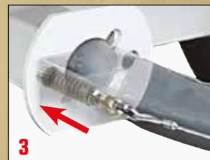
Dispositif d'attelage “Sécurité” breveté. Homologué par l'UTAC suivant le règlement 55 de la CEE-ONU - **Brevet ALTRAD.**
