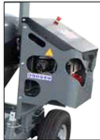
**Versions moteurs essence Robin/Subaru ou Honda** avec sécurité d'huile, bouton d'arrêt d'urgence, transmission par courroie poly-V.
