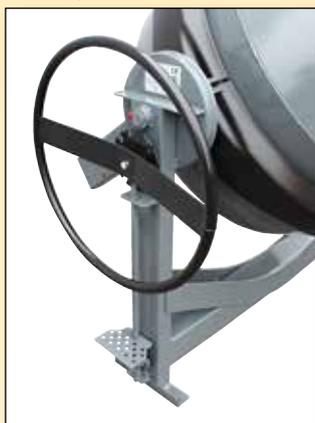
Verrouillage et déverrouillage de la cuve par pédale
