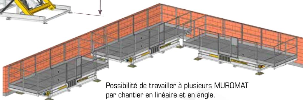
Possibilité de travailler à plusieurs MUROMAT par chantier en linéaire et en angle.
