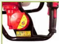
Embrayage centrifuge avec système de décompression
