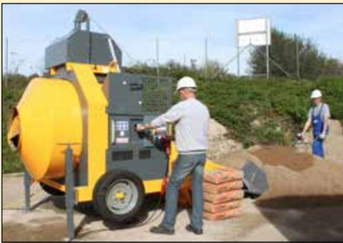
• La RB400H version diesel est équipée avec un groupe électrogène diesel Hatz 1B40 d'une puissance de 7 kVA (démarrage manuel). Quand la bétonnière n'est pas en fonctionnement, vous pouvez utiliser le groupe électrogène pour raccorder divers matériels de chantier (ex : meuleuse, disqueuse, nettoyeur haute pression, etc...). Sur les chantiers possédant l'électricité, vous pouvez raccorder votre bétonnière au réseau sans utiliser le groupe électrogène.
