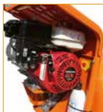
**Moteur thermique Honda GX120** avec accélérateur variable
