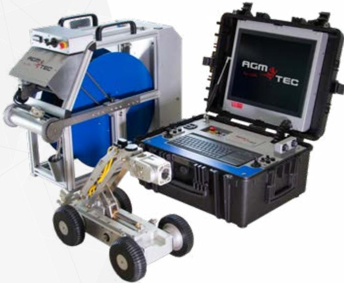
Le robot d'inspection 600 AX permet d'intervenir dans un plus large diamètre de canalisation que le 300 AX. Comme ce dernier, il analyse sur-mesure des réseaux d'assainissement et d'évacuation. Le robot d'inspection est le seul équipement capable de détecter les défauts de pente à 0,01 %, contrôler l'ovalisation des réseaux, calculer la dimension des fissures ou tout autre défaut.
