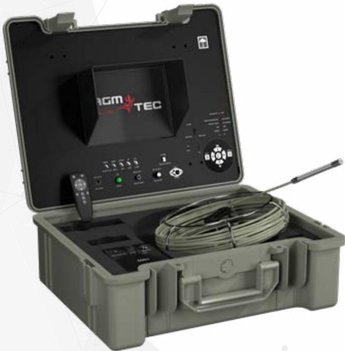
Utilisable par un seul opérateur, la caméra d'inspection Tubicam® R14 est idéale pour visualiser les petites canalisations et les tuyaux de piscines grâce à sa tête Ø14 mm sur des diamètres allant de Ø20 mm à Ø70 mm, jusqu'à 20 mètres de distance.
