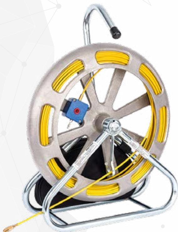
La recherche de tubes non conducteurs est simplifiée avec une aiguille détectable pour localisation de lignes. Le système de localisation de ligne convient pour suivre l'ensemble des tracés de lignes. Seul le câble émetteur est raccordé à la bobine de localisation, le deuxième raccordement est mis à la terre.
