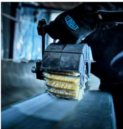
**TYROLIT Power** révolutionne la finition des surfaces dures. Des bandes de ponçage constituées de plusieurs couches de poils de cactus et de diamant assurent une extrême dureté, font gagner du temps et réduisent considérablement les vibrations ressenties par l'utilisateur.
